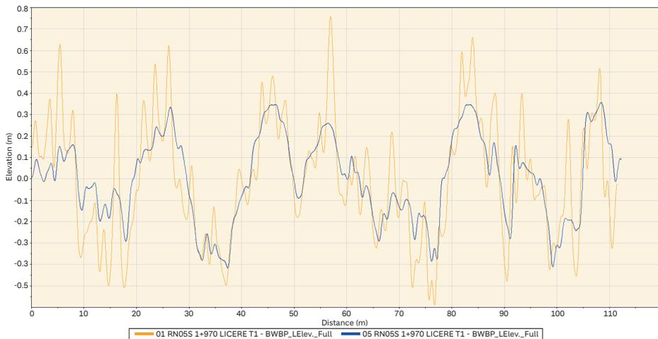
**FIGURA 3 PERFIL LONGITUDINAL ANTES Y DESPUÉS DE DIAMOND GRINDING.**
